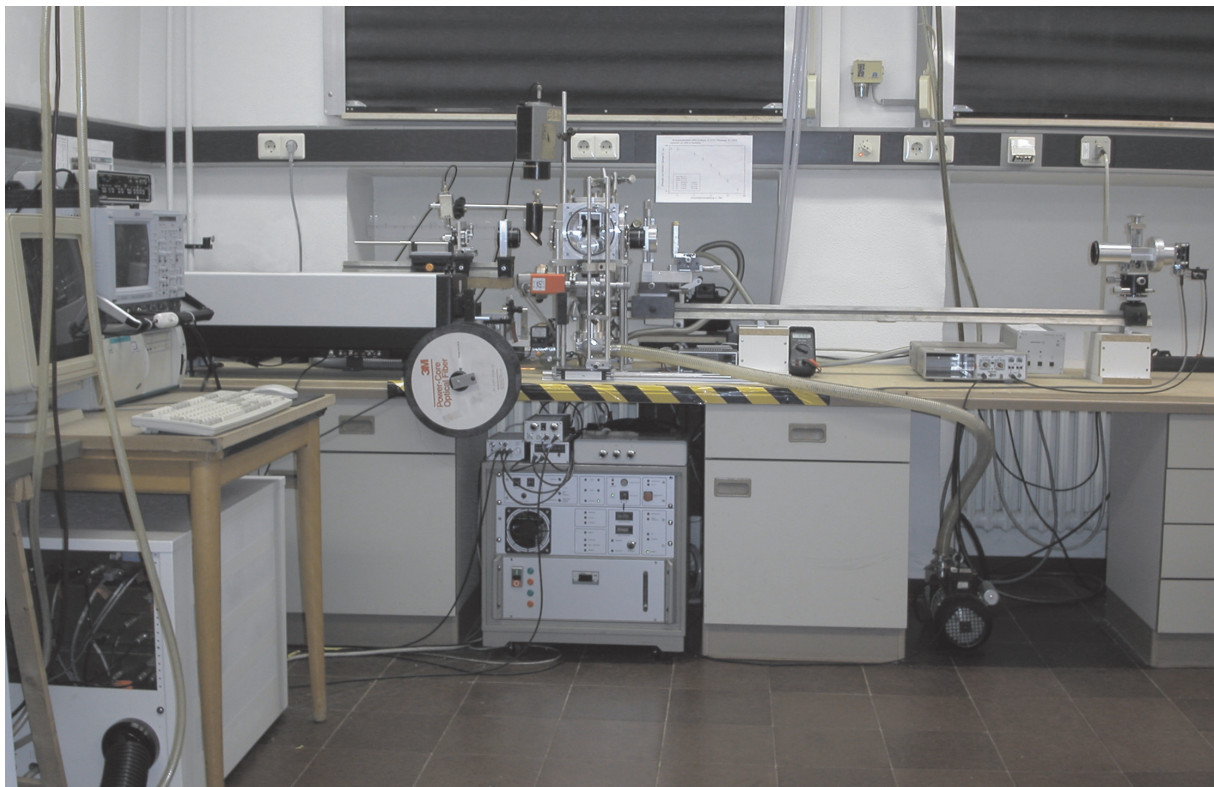
Abbildung 3.5: Experimenteller Aufbau zur Hochgeschwindigkeitsphotographie. Auf der Werkbank befindet sich links der Beleuchtungslaser und im Zentrum der Er:YAG-Desorptionslaser und die Vakuumversuchskammer. Das Kameramodul ist rechts auf der optischen Bank angeordnet. Detailaufnahmen finden sich in Abbildung 3.7, in Abbildung 3.11 und in Anhang A.
