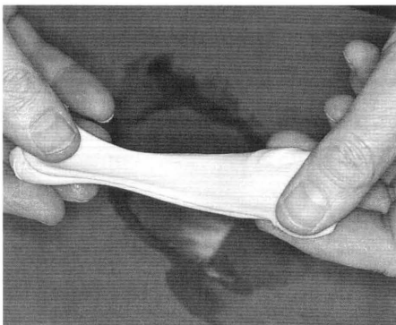
Abb. 56 Einmischen des Härters durch In-die-Länge-Ziehen und Zusammenklappen
