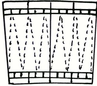
Abbildung 3.0.4.: Skizze der Skalenunterteilung. Um Minuten abzulesen, waren die 10- Minuten Intervalle durch unterbrochene Diagonalen geteilt.
