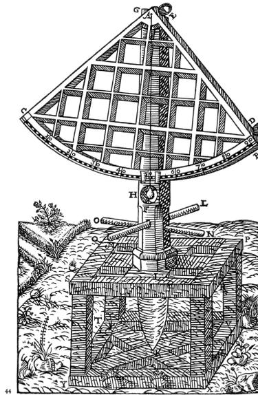
Abbildung 3.0.1.: Der Augsburger Quadrant mit 14 Ellen Länge. Die Verstrebungen waren im Boden verankert.
