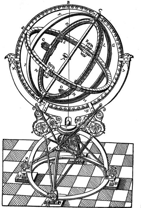
Abbildung 3.0.9.: Armillarsphäre zur Messung von Stundenwinkel und Deklination.
