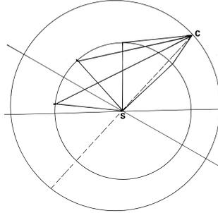
Abbildung 5.6.2.: Konfigurationen zur Rekonstruktion der Erdbahn. Die Richtungen von der Erde zur Sonne sind aus der Zeit bekannt, zum Mars werden sie gemessen. In den Dreiecken Sonne– Erde– Mars sind also jeweils eine Seite — die Entfernung Sonne– Mars — und zwei Winkel gegeben. Die Sonne in S und der Mars in C wirken wie zwei Leuchttürme, mit deren Hilfe die Erde ihre Position bestimmt.
