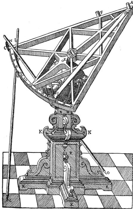
Abbildung 3.0.7.: Sextant für zwei Beobachter mit 4 Ellen Seitenlänge. Er wird auf eine Säule mit Kugelkopf aufgelegt.
