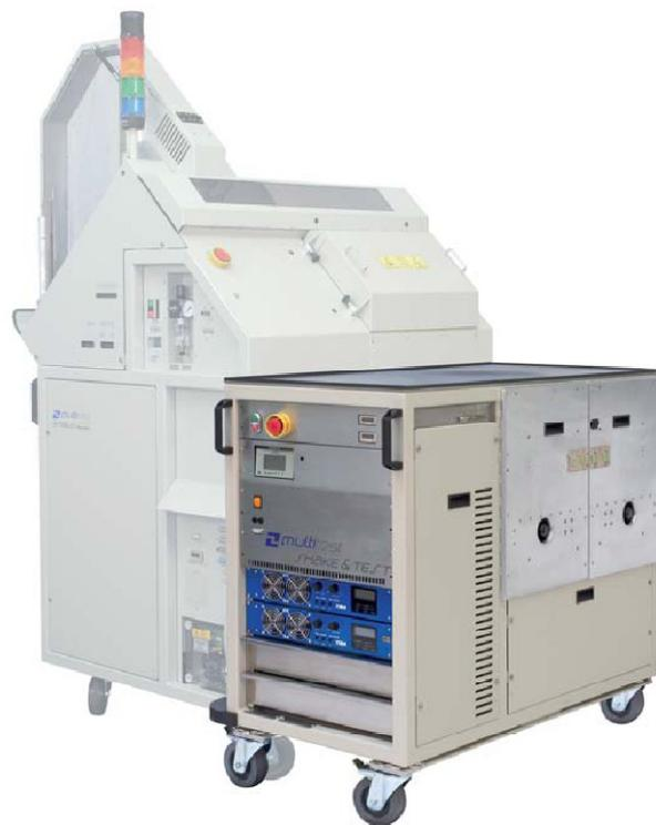
Abbildung 15 Handlingsystem Beschleunigungsmessung [MUL08]
