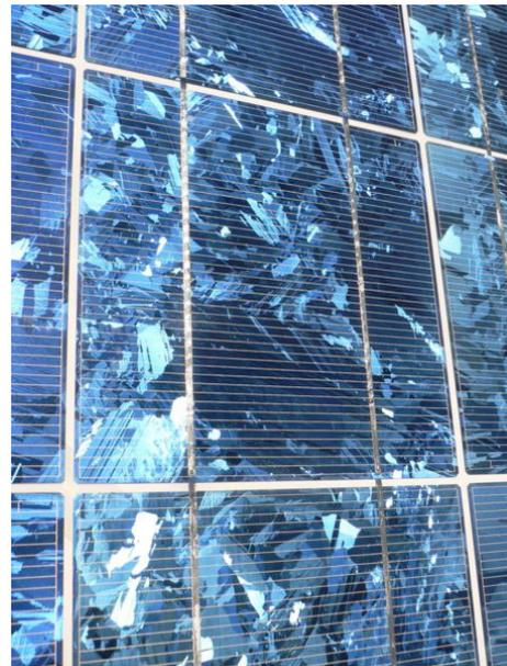
Abbildung 18 Polykristalline Solarzellen [SLIK06]
