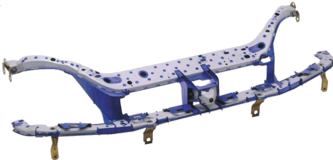
Abbildung 2-2: Anfänge der Hybridbauweise im Fahrzeugbau am Beispiel des Hybrid-Frontends des Ford Focus C170 aus dem Jahr 1999 [4]
