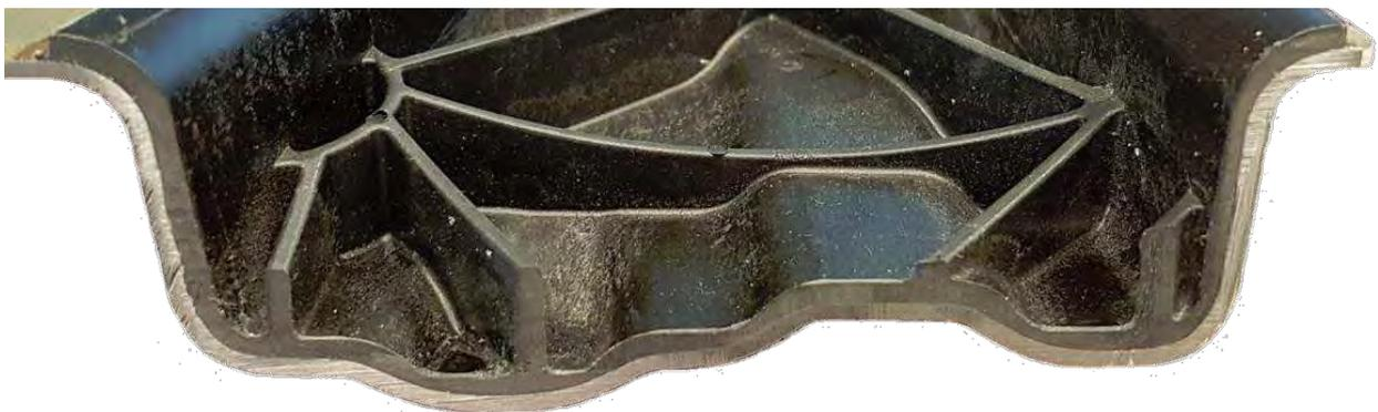
Abbildung 6-9: Schnitt durch einen hybriden Längslenker
