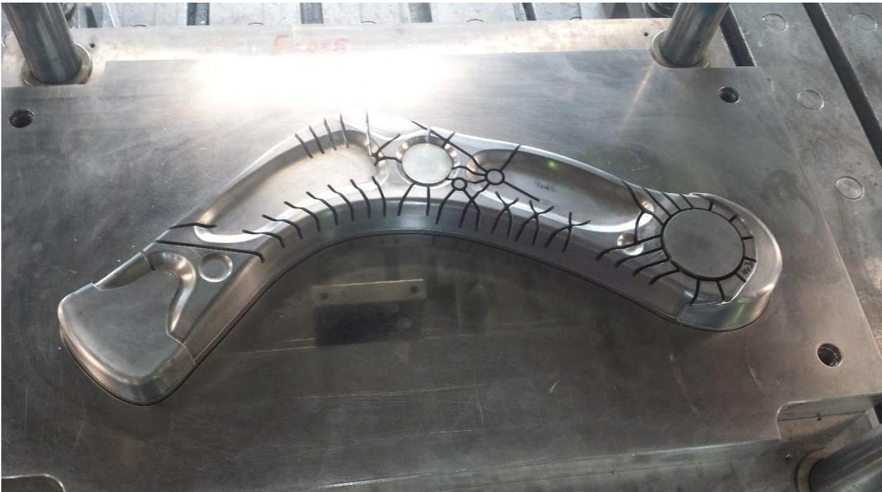
Abbildung 6-10: Werkzeug zur Fertigung des hybriden Querlenkers bei Inbetriebnahme
