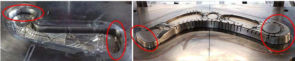
Abbildung 6-2: Schließen der offenen Enden beim Längslenker- (li.) und Querlenker-Werkzeug (re.) um eine geschlossenen Wanne zu erzeugen
