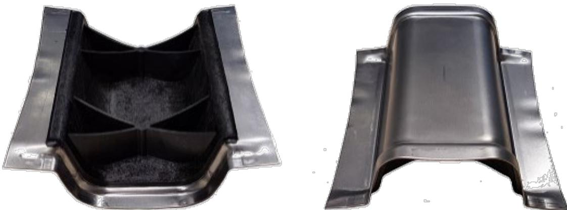
Abbildung 4-7: Durch Hybridpressen hergestelltes U-Profil [28]
