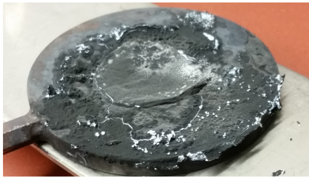
Abbildung 7.17.: Foto des Produkts der versuchten Verbrennung von Natrium in \text{CO}_2 . Eine Zündung war nicht erfolgreich. Es bildete sich eine grau bis schwarze Oberfläche.
