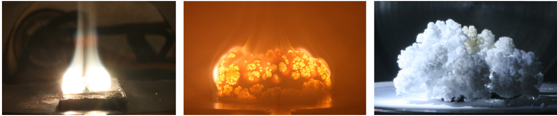
Abbildung 2.2.: Fotos der Verbrennung von Lithium in Luft mittels Hochspannungsentladung unter Bildung des außen farblosen, spröden Verbrennungsprodukts.
