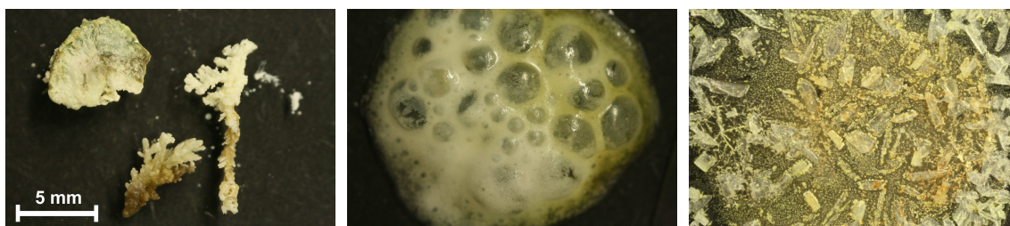
Abbildung 7.4.: Verlauf der Zersetzung des Verbrennungsproduktes von Natrium an Luft in Luftatmosphäre bei Raumtemperatur. ( Links ): Beginn der Lagerung in Luft, ( Mitte ): vollständige Zersetzung nach ca. 20 min, ( rechts ): Trocknung des Rückstands in kristallines NaOH über Nacht.
