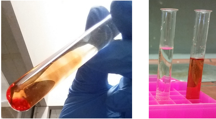
Abbildung 7.25.: Foto des Eisen(III)-Nachweises am Verbrennungsrückstands von Natrium in Luft ( links ) und dem Vergleich zum Negativtest des bei der Verbrennung entstehenden Aerosols ( rechts ).
