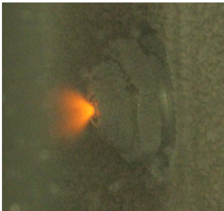
Abbildung 7.20.: Foto der Spraybrennerflamme von Natrium in Luft bei einem Luftfluss von 30 slm und eingestellter Düsenöffnung 2 (1,61 mm 2 ).
