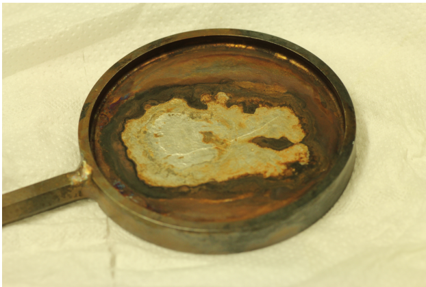
Abbildung 7.24.: Foto der Auflagefläche des Natriums für die Verbrennung im Reaktor direkt nach der Reaktion zur Veranschaulichung der Abnutzung des Edelstahls durch das Metall und seiner Verbrennungsprodukte.
