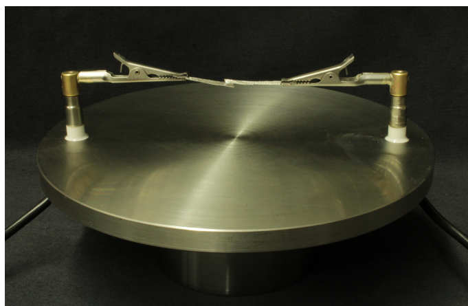
Abbildung 5.6.: Foto der Plattform zur Verbrennung von Magnesium im Reaktor mittels Widerstandsheizern.
