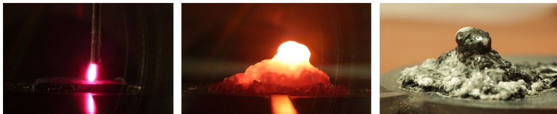
Abbildung 2.3.: Fotos der Verbrennung von Lithium in \text{CO}_2 mittels Hochspannungsentladung unter Bildung des grau-schwarzen, spröden Verbrennungsprodukts.
