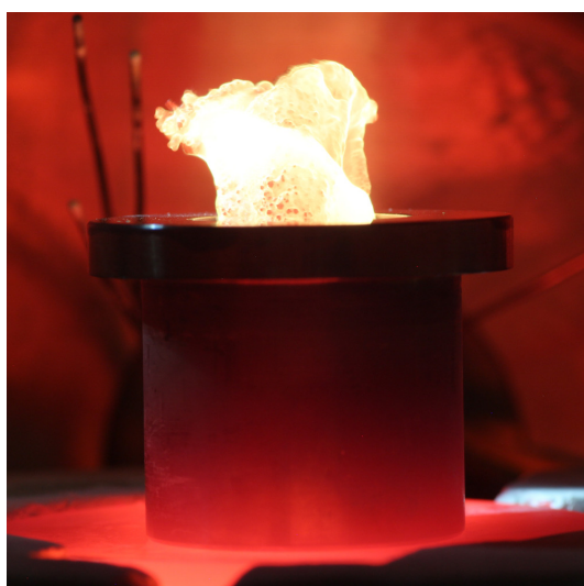
Abb. 9.28: Reaktion von 2,5 g Li in 800 mbar N 2 und 200 mbar Ar in einem beheizten Tiegel. Belichtungszeit 30 s.
