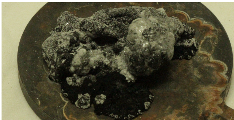
Abb. 9.36: Foto des Verbrennungsprodukts von 1 g Li in einer 400 mbar Luft/400 mbar CO 2 /200 mbar Ar-Atmosphäre.
