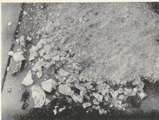
Bild 282. Sprengwirkung des gebrannten Kalkes beim Hinzutreten von Wasser, die Flasche wurde vollständig zertrümmert
