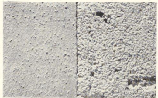
Bild 226. Zweischichtiger Putz aus Mainsand. 1. Schicht 1 Teil Jurakalk, 4 Teile Mainsand (rechte Bildhälfte). 2. Schicht 1 Teil Jurakalk, 2 1/2 Teile gesiebter Mainsand, gefilzt, mit Kalkmilch mehrmals lasiert
