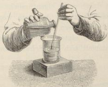
Fig. 672. Mischen von Schwefelsäure mit Wasser.
