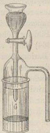
Fig. 826. Ozonbildung durch Zersetzung von Kaliumpermanganat.
