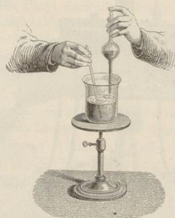
Fig. 680. Neutralisation von Kali durch Schwefelsäure.
