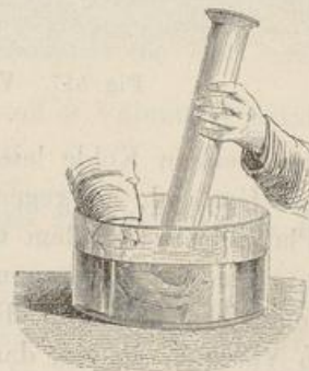
Fig. 521. Absorption von Kohlensäure durch Wasser.
