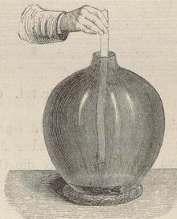
Fig. 820. Darstellung von Ozon durch Phosphor.
