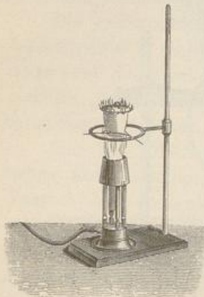
Fig. 648. Umwandlung von Antimonoxyd in -sulfid.
