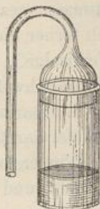
Fig. 826. Ozonbildung durch Zersetzung von Kaliumpermanganat.
