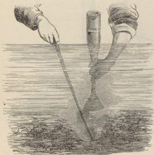
Fig. 861. Auffangen von Sumpfgas.
