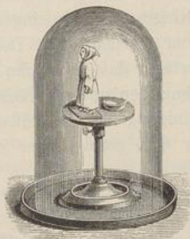
Fig. 673. Wasseranziehung durch Schwefelsäure.
