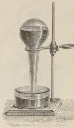
Fig. 651. Umwandlung von Wasser in Chlorwasserstoff.
