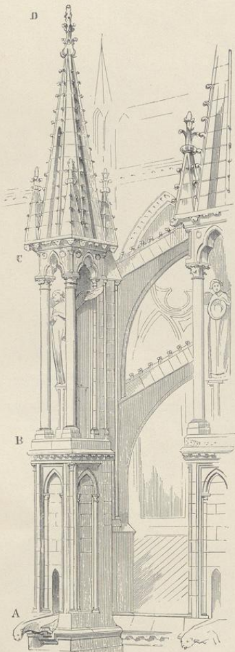
3. Strebepeer von der Kathedrale zu Rheims. A. Wasserspeier. B—C. Baldachin. C—D. Fiale mit vier Nebenfialen.
