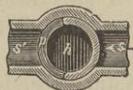
Abb. 116. Wenn die Abflüßöffnung zum Zweck des Nachsehens oder Reinigens des Ventils abgestellt ist.
