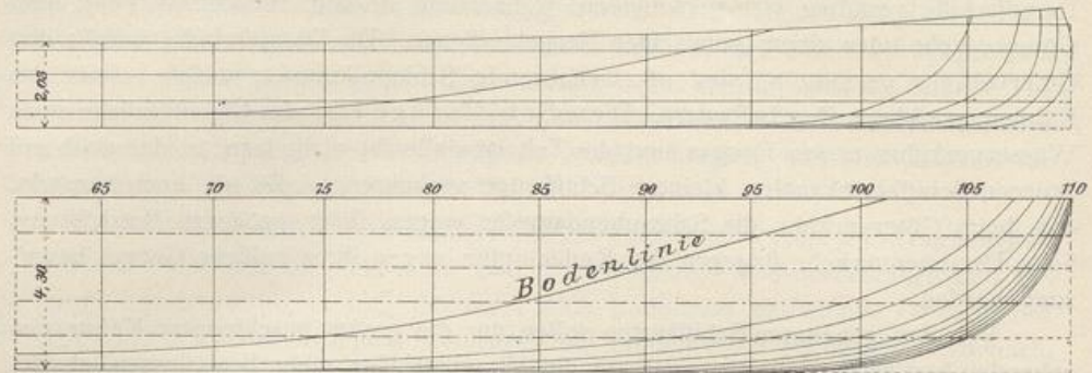
Abb. 145. Längsriß und Wasserlinienriß, M. 1:200.
