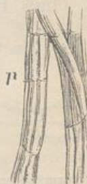
Leinenfaser aus irländischer Leinwand. p Porenkanal 200mal vergr.
