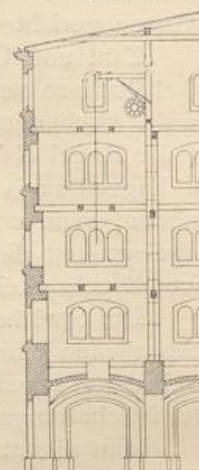
Querschnitt eines Bodenspeichers.
