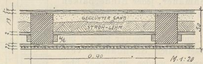
Abb. 35. Stakung mit Lehm und geblühtem Sand, 13 cm stark.
