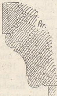
Dom von Bremen. Deckgesims der Kryptensäulen. (Franz Kugler.)
