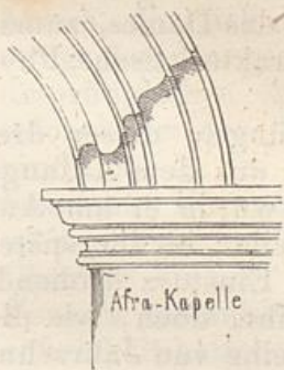
Dom zu Speyer. Kämpfergesims und Archivolt der Afrakapelle. (Nach v. Quast.)
